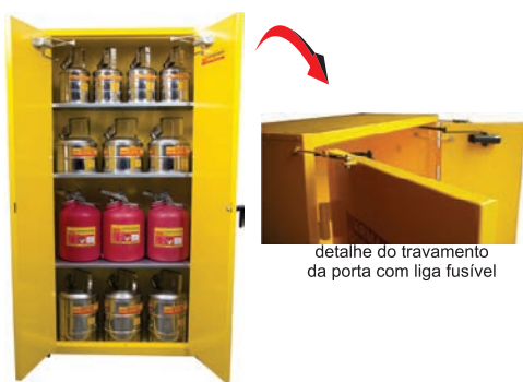
Armário corta fogo c/ porta de retorno automático e sistema de destravamento por liga fusível 1000 x 1000 x 450 cód. TK11063 2000 x 1000 x 450 cód. TK11064
